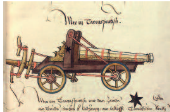
Im 15. Jahrhundert entwickelte sich nach den Handfeuerwaffen und den großen Belagerungsgeschützen die leichte Artillerie. So genannte Tarrasbüchsen, für die mehreckige lange Rohre charakteristisch waren, postierte man vor allem auf den Terrassen von Festungsbastionen. Für den Feldeinsatz dieser noch im 16. Jahrhundert aktuellen kleinkalibrigen Geschütze dienten mobile Lafetten.
